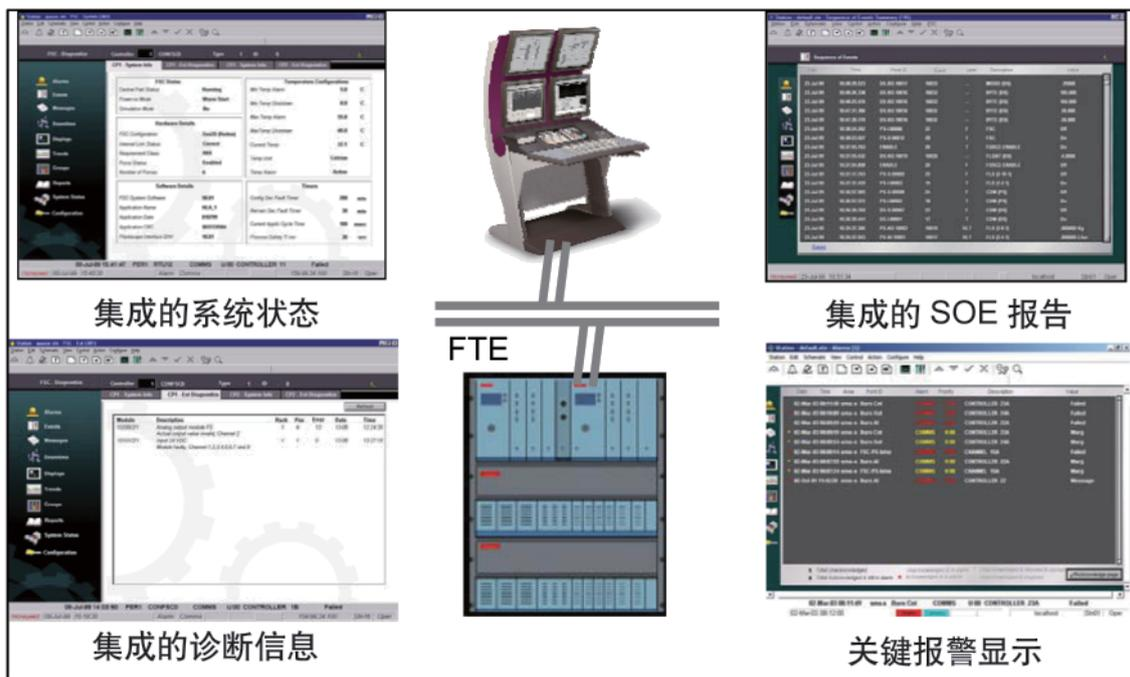
图37. PlantCruise提供SOE，SM诊断信息和报警信息的集成
