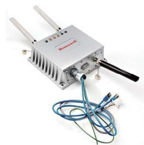
OneWireless™（版本R110）的多功能节点可以构建一个工业用的、冗余mesh通讯的无线网络，把过程控制网络延伸到现场。OneWireless多功能节点是目前市场上唯一的，可以用在工业危险环境1类2区 / ATEX 2区，支持符合工业无线标准的多种过程控制应用的无线设备。这些标准包括IEEE 802.11标准（支持的无线设备如笔记本电脑、手持终端、无线摄像头CCTV等），以及ISA100.11a标准（支持无线变送器等无线设备）。在工厂安装以后，这些多功能节点可以自我组织、自我愈合、自我管理，相互通讯，构建一个可靠、安全的无线mesh网络，传输过程参数和维护诊断信息，支持移动的工作站。这个网络通过OPC、Modbus TCP、Modbus RTU等标准通讯方式把由电池供电的无线变送器所采集的过程数据集成到控制系统的控制器中。
