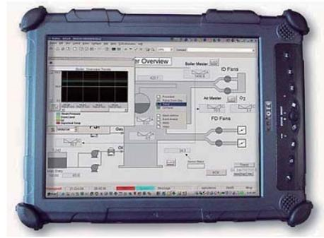
这些耐用的Tablet PC适用于环境恶劣的工业场合，带有镁制底盘和专利化的内部机框。它们所用的屏幕采用了专利技术，降低了反射率和眩光，从而提高了屏幕在各种环境条件下（包括日光直射）的显示能力。而且这些平台在危险等级评定中经认证符合UL 1604第1类第2部分以及ATEX 2区第3类的要求。
